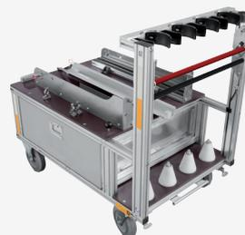
Zur senkrechten Lagerung der Saugschläuche hinter dem Schubbügel, die Schublade zur Lagerung des Zubehörs ist unter der Tragkraftspritze platziert
